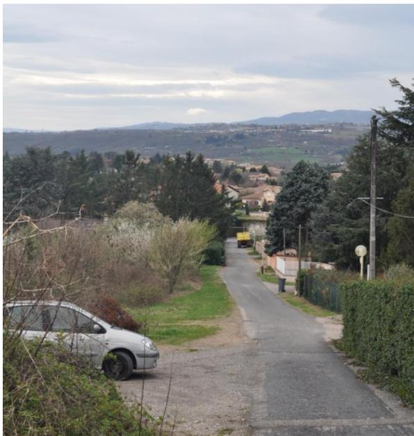
Aucun indice d'instabilité de surface n'a été observé dans ce secteur. Les faibles pentes formées dans les moraines consolidées et apparemment naturellement drainées sont peu propices au déclenchement d'un glissement. De même, la probabilité des coulées de boue est très faible. La topographie très régulière du secteur (absence de ruptures de pentes) nous conforte dans ce jugement.
